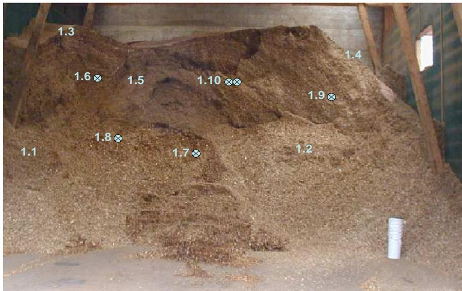
**Figure 4 :** Tas de plaquettes du site de transformation et de stockage de Jussy (GE), échantillonné le 30 novembre 2006. Les échantillons 1.1 à 1.5 ont été pris en surface, alors que les échantillons 1.6 à 1.10 (désignés ainsi : ⊗) ont été pris plus en profondeur, au fur et à mesure que la pelle mécanique extrayait les plaquettes. L'échantillon 1.10 est issu de la profondeur la plus importante.
