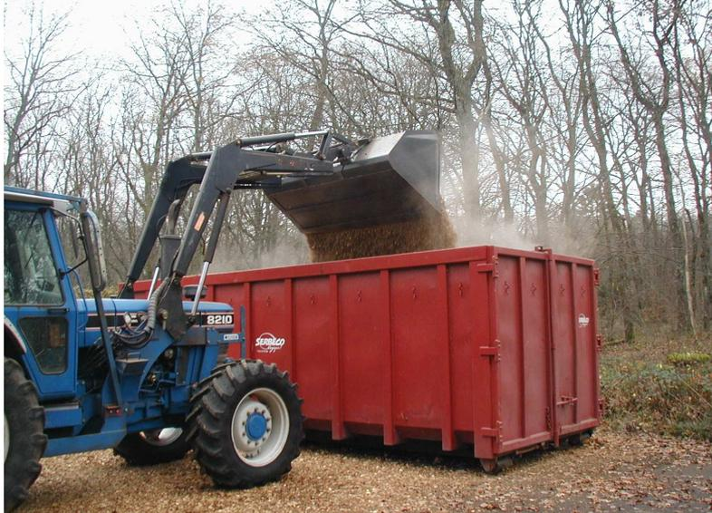
**Image 1 :** Pelle mécanique remplissant une benne de plaquettes. Le godet contient environ 2 m<sup>3</sup> de matière.
