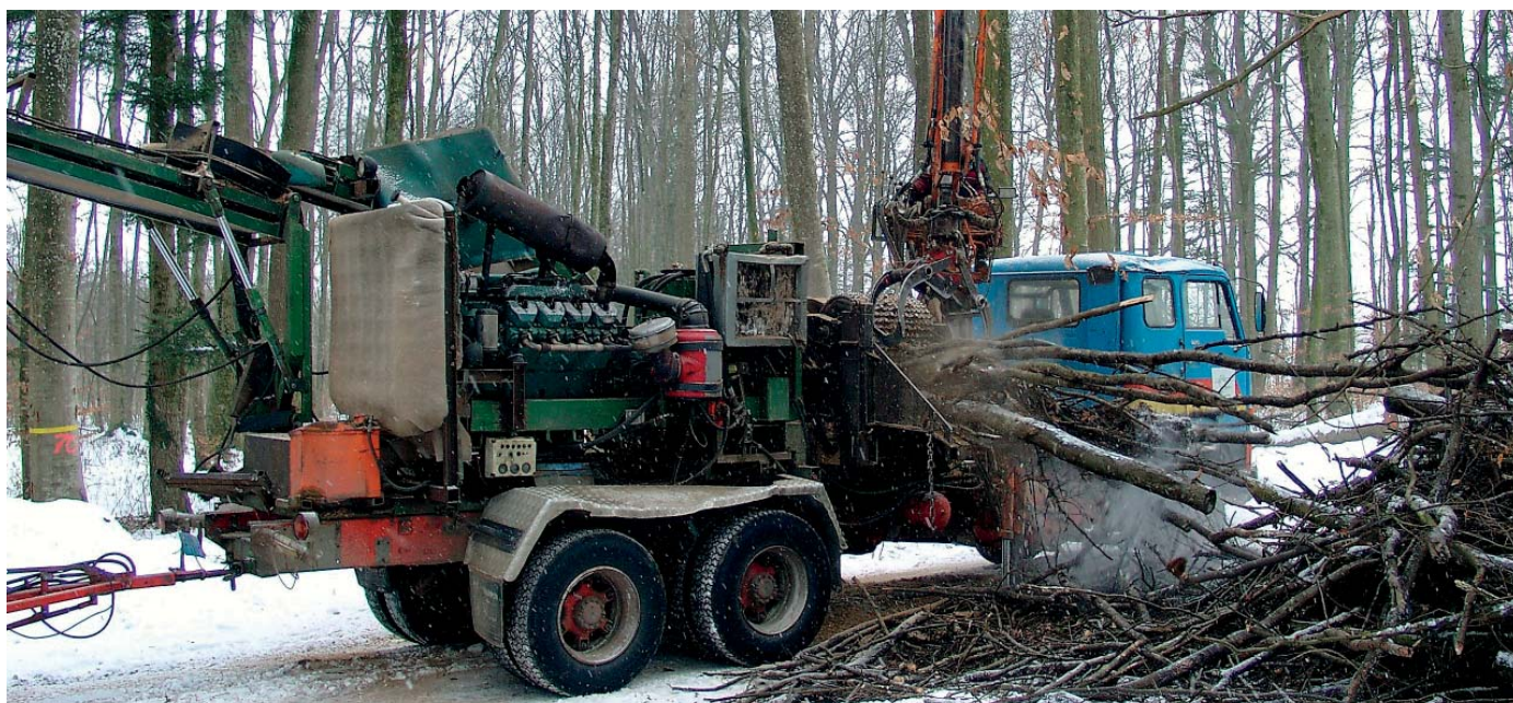
Production de plaquettes de bois à partir de rémanents de coupe de branches.
