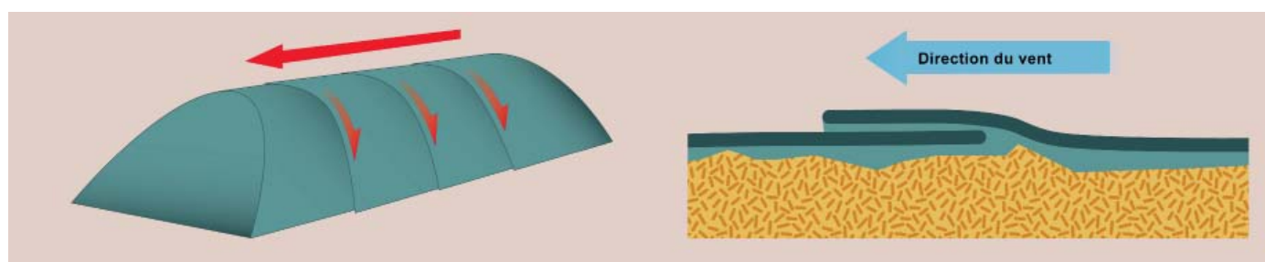
Couvertures en non-tissé et direction du vent (source: Forêts domaniales de Bavière).
