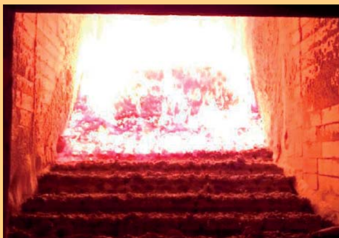
Occupation optimale des grilles sans surproduction d'oxygène (ardens GmbH, 2017).
